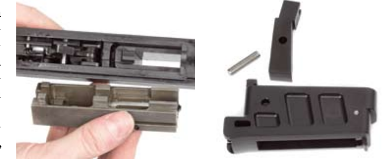
Lukko osuu liikkeessaan polymeeripintoihin, joten koneisto kannattaa pitää öljyttynä.
