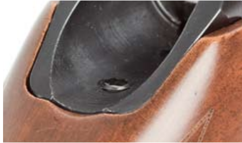
Kun kiinnitysruuvit ovat tiukalla, niistä taaempi pistää esiin kehuksesta osuen lukkoon. Kunnolla kiristettynä se estää lukon käyttämisen kokonaan.
