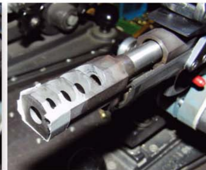
Das abgerissene Gewebeband an der letzten, mündungsnahen Expansionskammer zeigt deutlich, daß selbst bei der kleinvolumigen 9 mm Luger genug Gasdruck für eine effektive Wirkungsweise des Mündungsaufsatzes entsteht.
